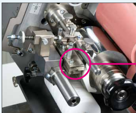
Img.: Cliché cilíndrico CP instalado en unidad rotativa de tampografía RTI 21-150
