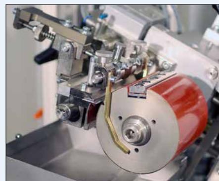
Img.: Cilindro de sujeción rotativo montado en la unidad rotativa de tampografía
