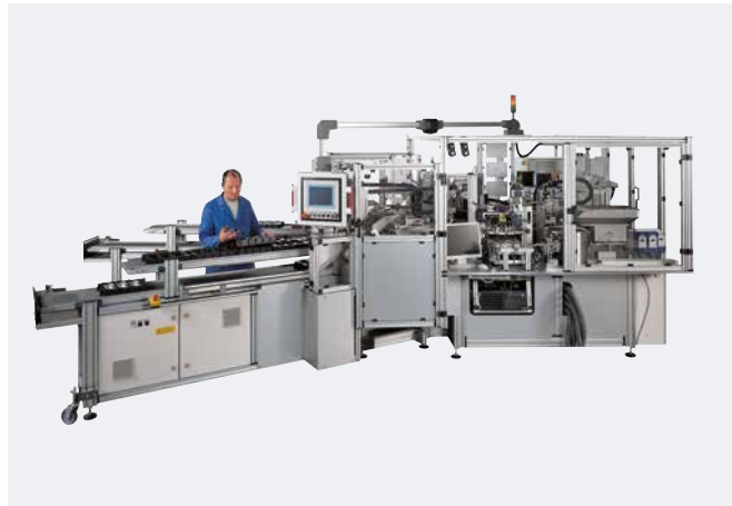
Instalación/prueba de sistema automatizado y marcado láser Paneles de salpicadero automotrices
